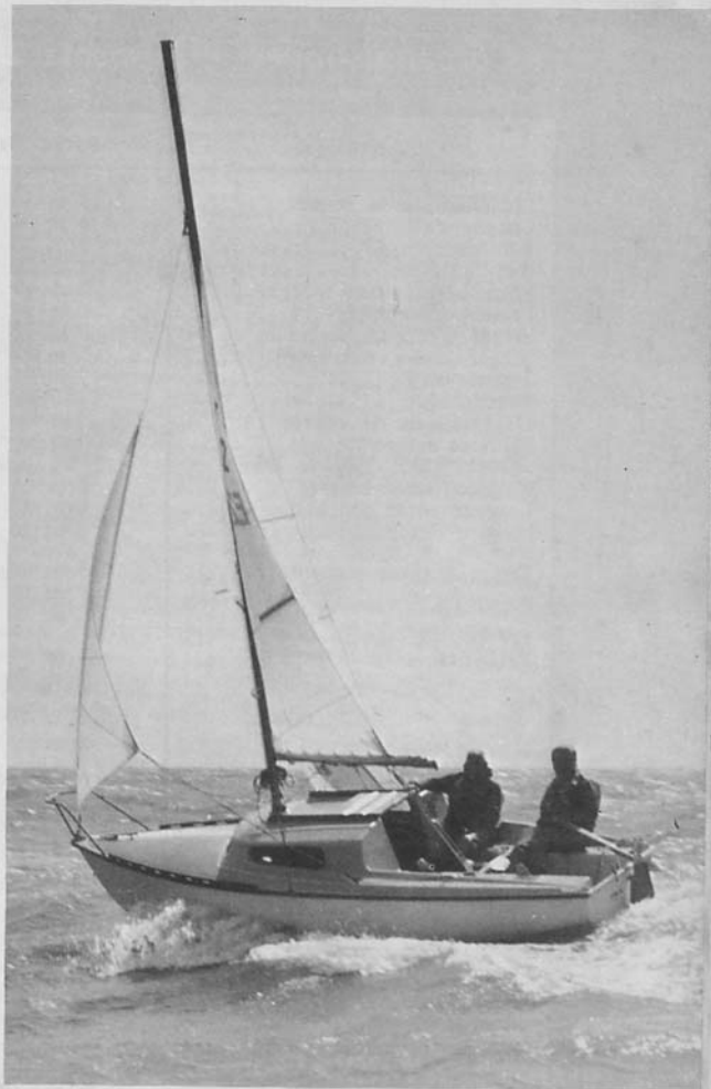
Sous petit foc et grand-voile à deux ris le bateau s'est trouvé bien équilibré, mais le tableau a un peu trop tendance à rester engagé, même si on évite de trop charger l'arrière.
